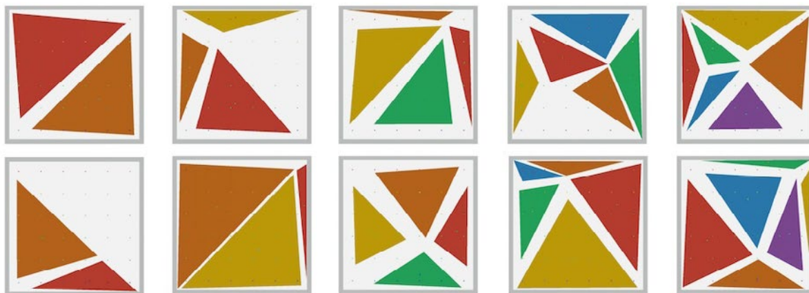
Ten rysunek przedstawia przykłady upakowania trójkątów 2D. Są to konfiguracje bezkolizyjne. Dzięki uprzejmości: Massachusetts Institute of Technology (MIT)
